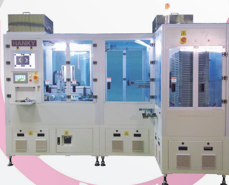
Model CL-1212CCD 單模印刷，每次印刷一片玻璃。
