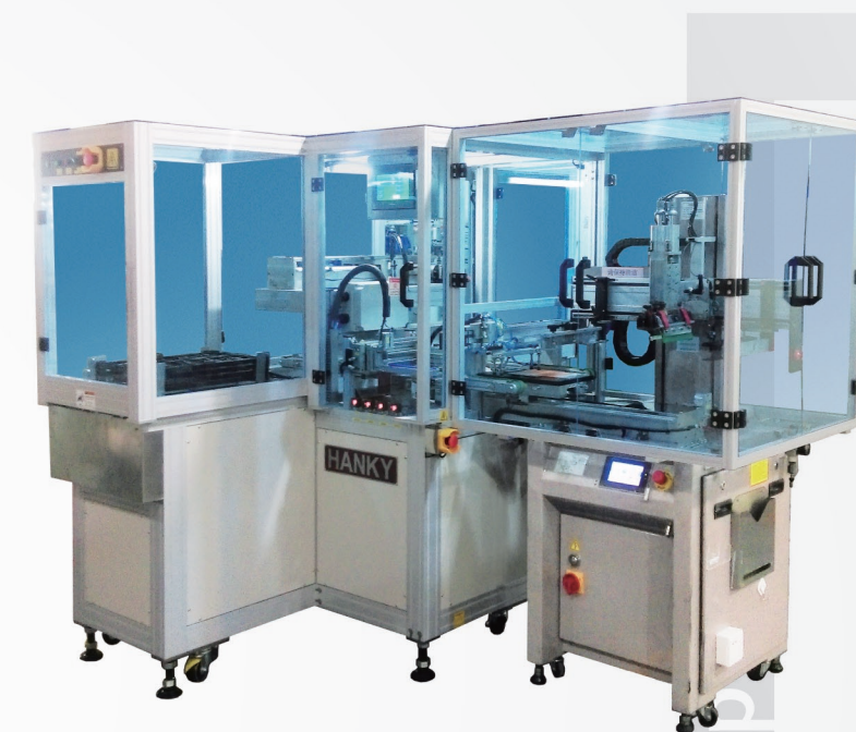
Model CL-850LD 单模印刷，每次印刷一片玻璃。
