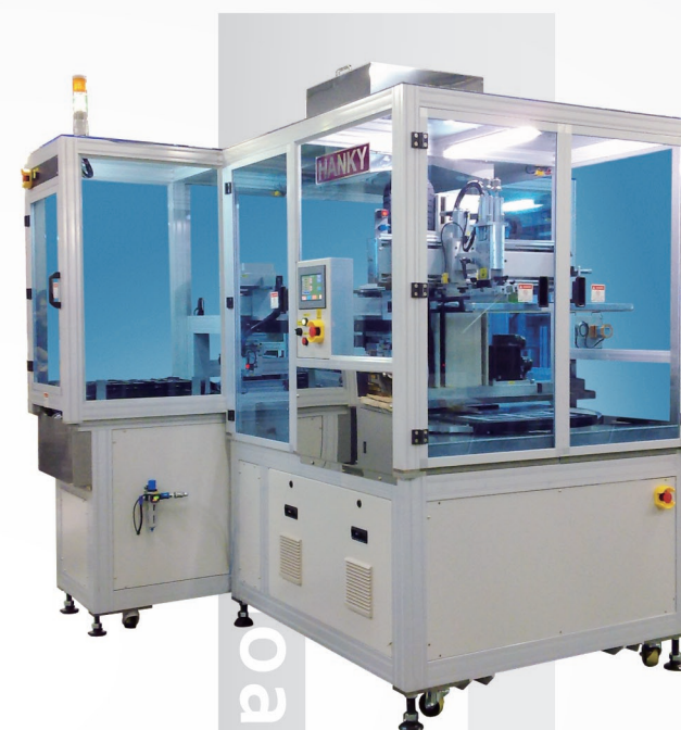
Model CL-2000T 双模/四模印刷，每次印刷两片/四片玻璃。
