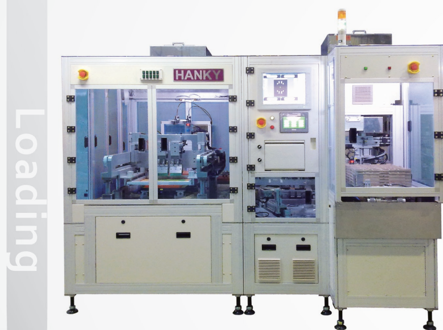
Model CL-2000CCD 双模印刷，每次印刷两片玻璃。
