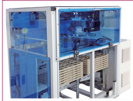
托盤自動堆疊裝置(不良品區)
