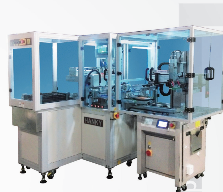
Model CL-850LD 單模印刷，每次印刷一片玻璃。
