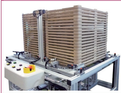
托盤自動堆疊裝置(完成品區)
